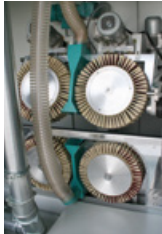
Programmgesteuerte Schwenkachse bringt das obere Schleifaggregat in Position
