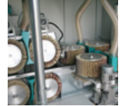
Vollautomatisches und allseitiges Schleifen von Profilen
