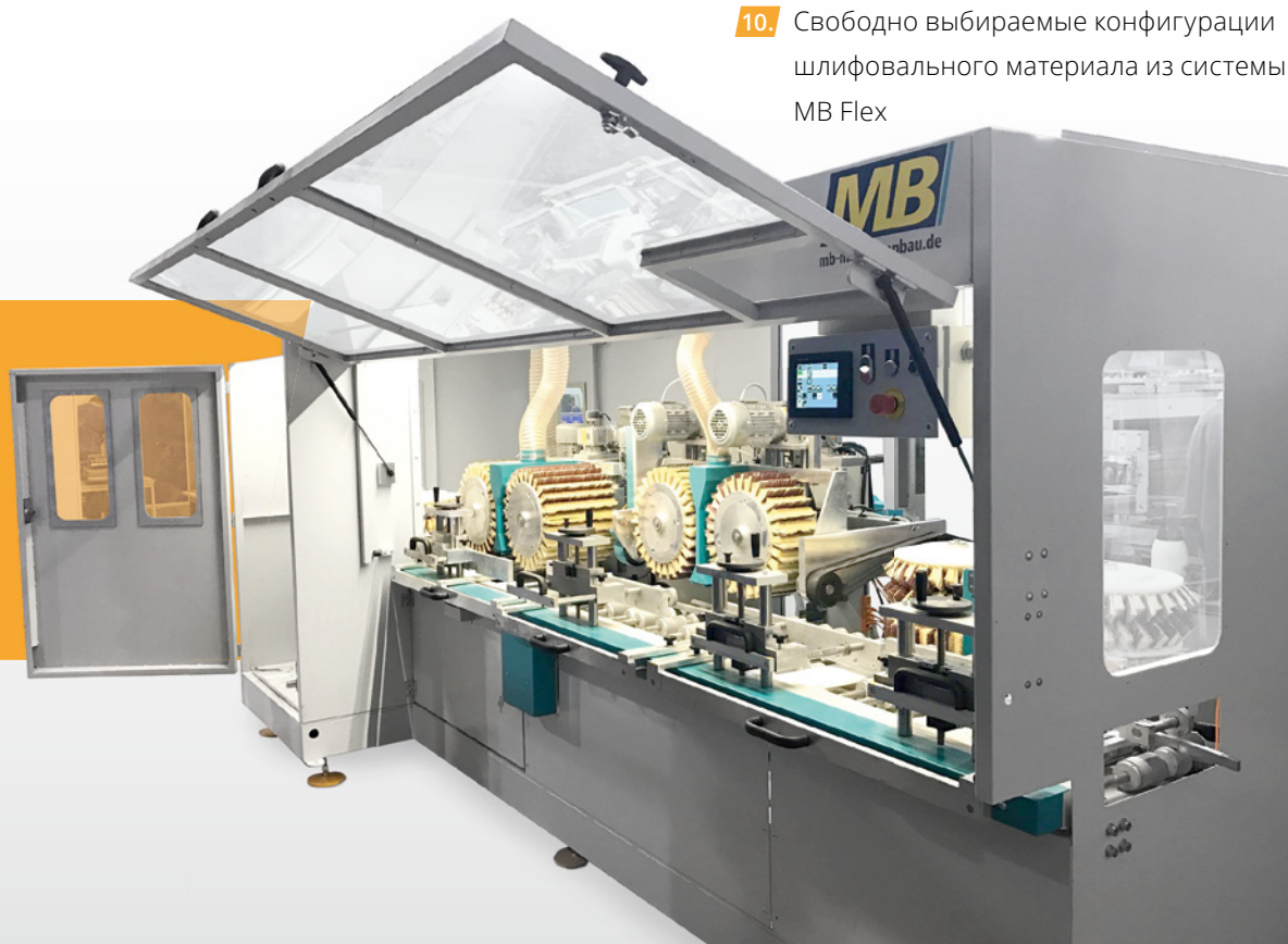
ROBA Profile благодаря шлифовальным агрегатам с двойными щетками гарантирует идеальный результат шлифовки
