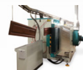
ROBA Big w wersji pionowej, zintegrowana z przenośnikiem podwieszanym
