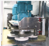
Agregat Profi Disk jako opcjonalne urządzenie dodatkowe zainstalowane na wlocie lub na wylocie maszyny
