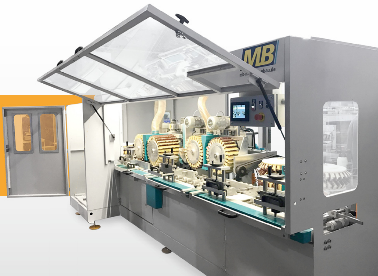
Szlifierka ROBA Profile z agregatem szlifującym ze szczotkami bliźniaczymi gwarantuje idealny rezultat szlifowania
